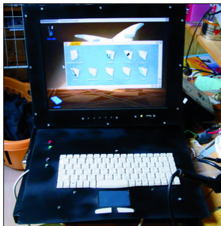
Abb. 61: Pegasos I als Laptop- Umbau (hier noch nicht vollendet) mit Mor- phOS 1.4.5 aus eigener Werkstatt
